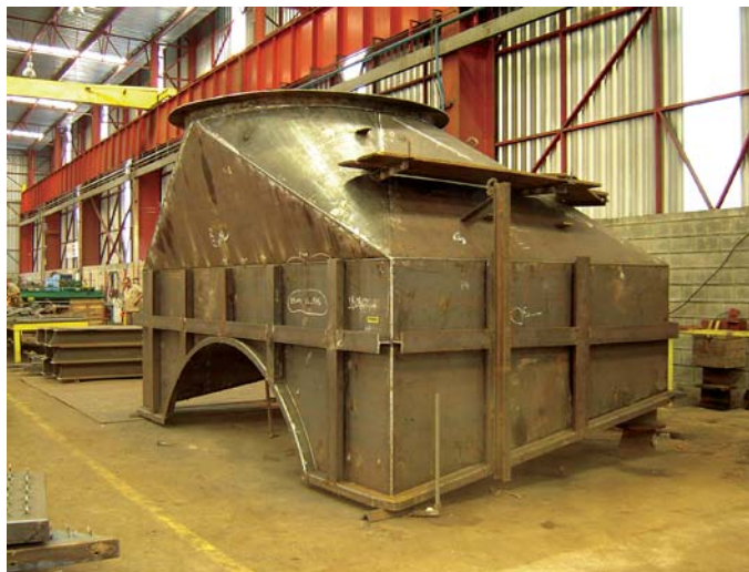
- Damper do Canal de Fumação para Forno de Reaquecimento de Blocos (Gerdau Açominas) - Cliente: Combustol - Peso total: 2.260 Kg
