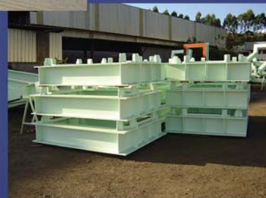
- Suportes para Estocagem e Plataformas (Área de Lingotamento - Gerdau Açominas) - Cliente: SMS Demag - Peso total: 155.780 Kg
