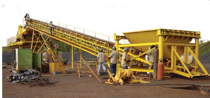
Abaixo: vista geral da peneira móvel, fabricada e montada pela Mecânica Industrial Nunes. O equipamento é dividido em três seções (peneira, transportador e chute de alimentação).
