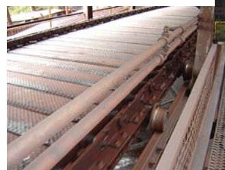
Vista geral do resfriador PBNK, na Usina de Pelotização (à direita). Abaixo: detalhe da esteira metálica do resfriador PBNK.
