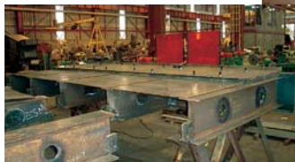
Acima: soleira de Alto-Forno. Projeto Combustol - Cia. Siderúrgica de Barra Mansa (RJ)
