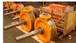
Acima e à direita: trucks de 2 rodas para estrutura de guindaste (5 e 6). Contrato com a ThyssenKrupp. Cliente final - Vale (PA).
