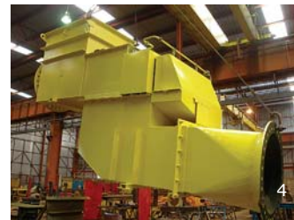
À esquerda e no topo da página: amostrador de poupa de minério (1 e 4). Contrato com a Outotec. Cliente final - Samarco (MG).
